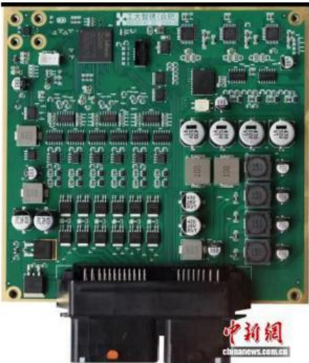
图为白先旭教授所介绍的一款自主研制的车规级电控悬架控制器。记者 吴兰 摄。
